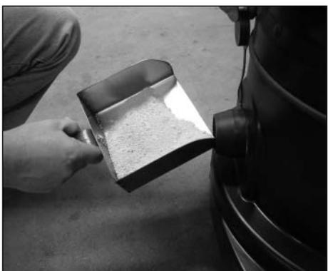
Allumez l'aspirateur et aspirer lentement env. 500 ml la substance filtrante (farine de calcaire) par le raccord d'aspiration.
