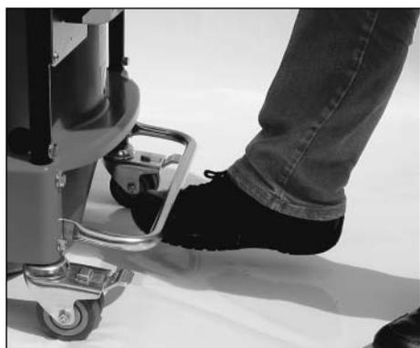
Lever la pédale sur le côté de l'appareil et abaisser le réservoir collecteur.
