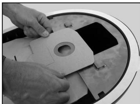
4. Insérer le sac dans la tôle de positionnement.
