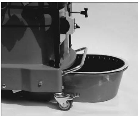
10. Placer un nouveau bac à déchets dans le réservoir collecteur et le repousser sous l'aspirateur. Éteindre l'aspirateur.
