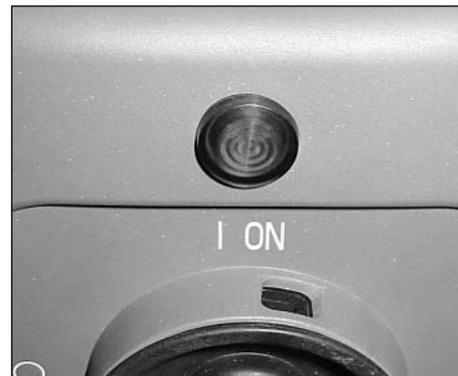
**Les modèles de type 1 et les modèles DS 1151, 1221, 1401** sont dotés d'un affichage du sens de rotation. Il s'allume si le sens de rotation n'est pas le bon. S'il tourne dans le mauvais sens, l'appareil n'aura pas de puissance et les courroies de transmission seront endommagées. En outre, la température de surface du moteur augmente et...
