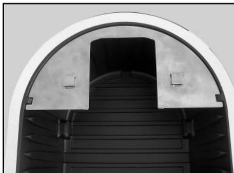
2. Insérer la tôle de positionnement.
