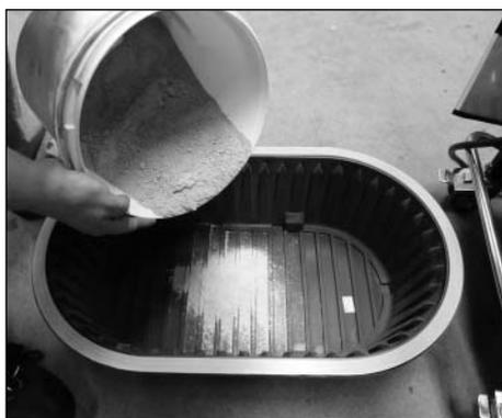
Placer un nouveau bac à déchets dans le bac à poussière. Remplir le bac à déchets d'environ 500 ml de farine de calcaire. La farine de calcaire est aspirée au niveau du filtre où elle adhère.
