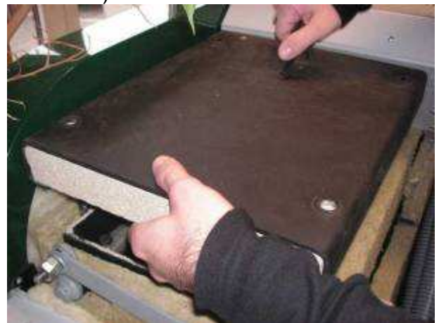
Abheben des Flugschendeckels
