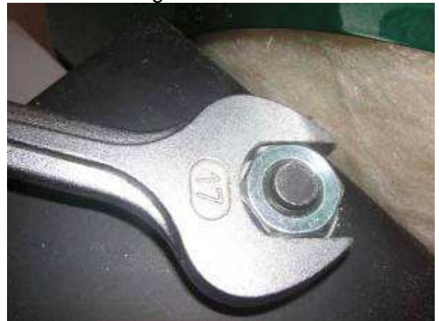
Öffnen des Flugschendeckels mittels entsprechendem Werkzeug (Gabelschlüssel Größe 17)
