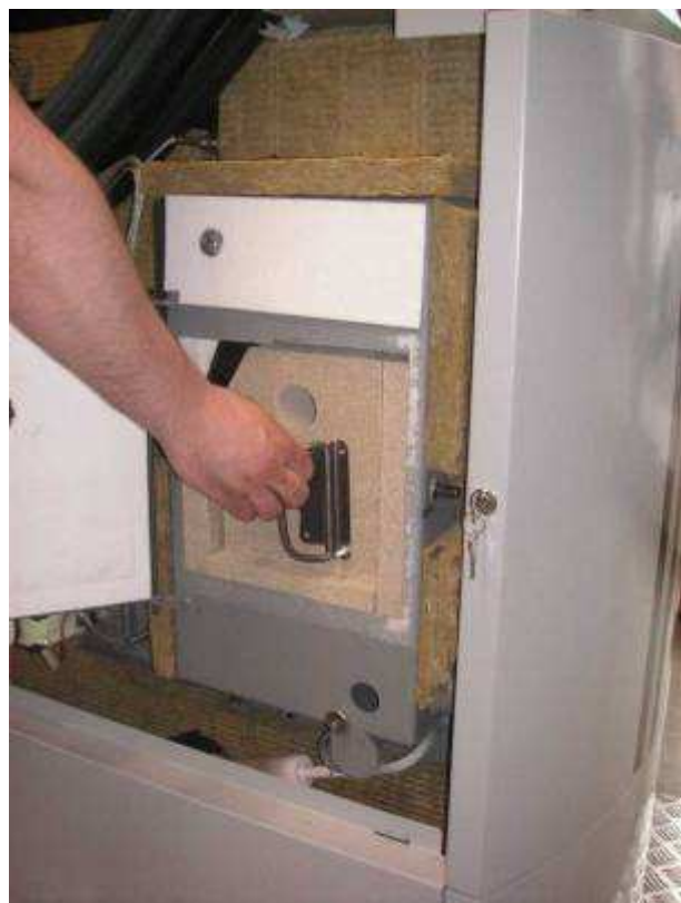
Herausnehmen der Brennraumisolierung
