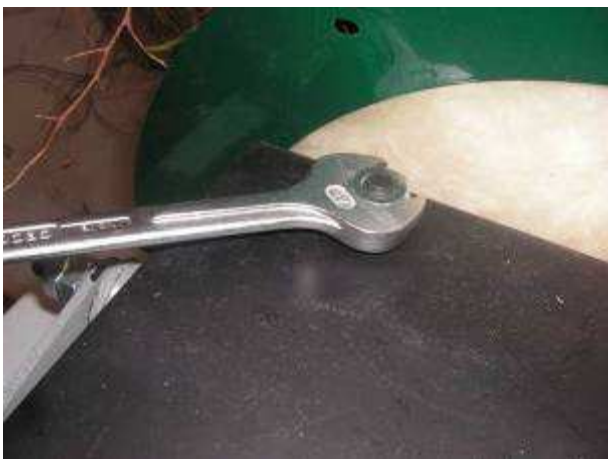
Öffnen des Flugschendeckels
