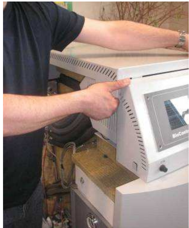
Öffnen der Oberverkleidung Nach oben weg heben.
