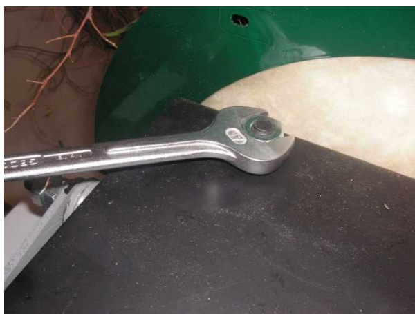
Ouvrir le couvercle du réceptacle de cendres volantes
