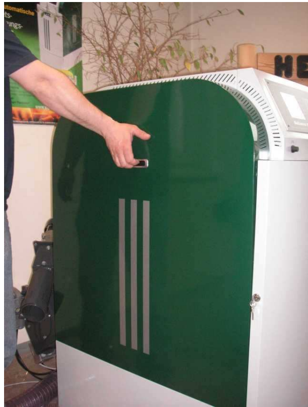
Démontage de la face latérale par le haut
