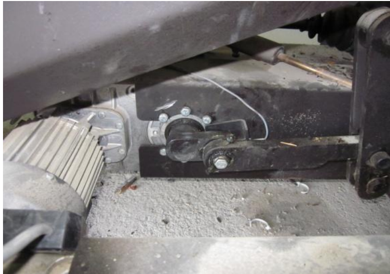
Lager schmieren und Sechskantschrauben nachziehen
