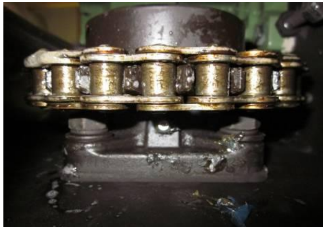
Kette schmieren (Hochdruckschmierspray FE 40) und spannen
