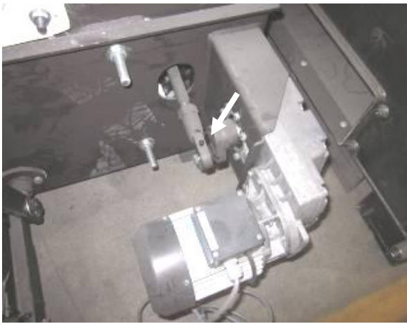
Lager schmieren motorseitig (Mobilux EP 2/NGLGI 2)
