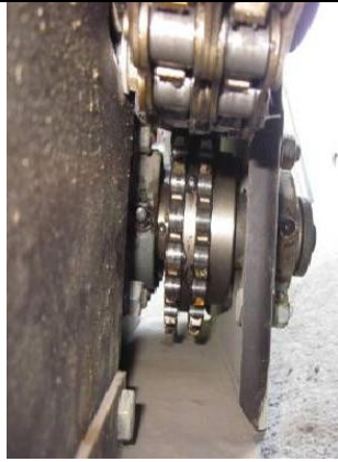
Lager innen und außen schmieren (Mobilux EP 2/NLGI 2)
