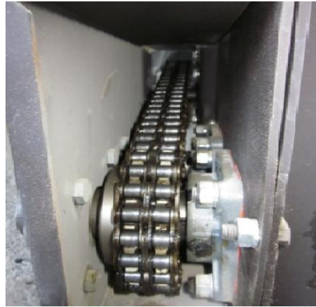
Kette schmieren (Hochdruckhaftschmierspray FE 40) und spannen
