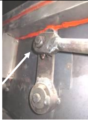
Lager schmieren Wipphebel (SKF Hochtemperaturfett LGHP 2/0.4)
