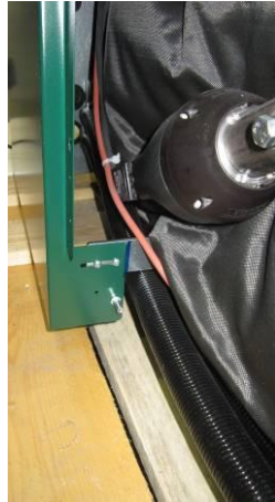
Schrauben (oben & unten) der Seitenverkleidung links hinten lösen
