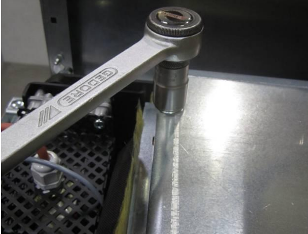
Entfernen des Flugaschendeckels mittels entsprechendem Werkzeug (z.B. Gabelschlüssel oder Ratsche → Größe 17)
