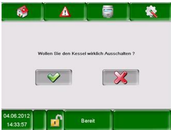
Bild 2.1: Ausschalten der Anlage bei eingegebenem Code
