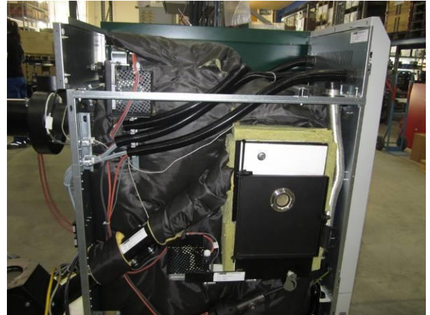
Abdeckblech und Seitenverkleidung links hinten entfernen
