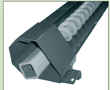
Stabiles Schneckenförder-system für Hackgut.
