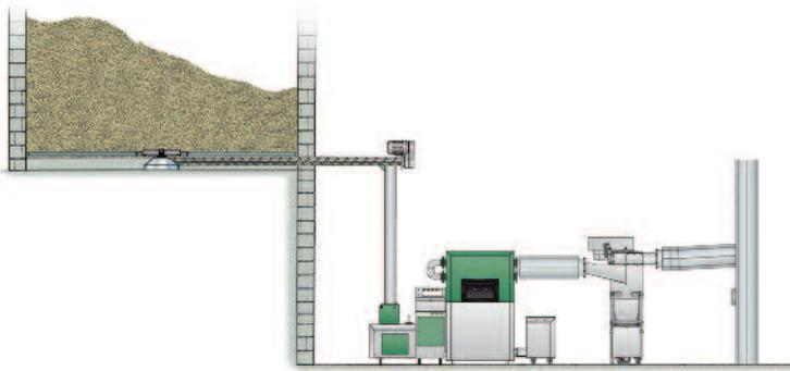
Lagerraum und Heizraum unterschiedliches Niveau.
