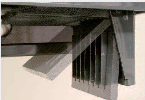
**Automatische Reinigung mittels Kipprost**
