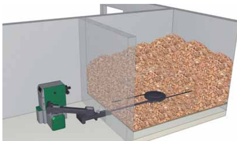
Raumaustragung über waagrechtes Federrührwerk mit Steigschnecke zur optimalen Lagerraumausnutzung
