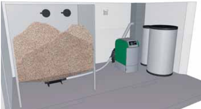
Raumaustragung mittels flexibler Austragungsschnecke aus einem Sacksilo.
