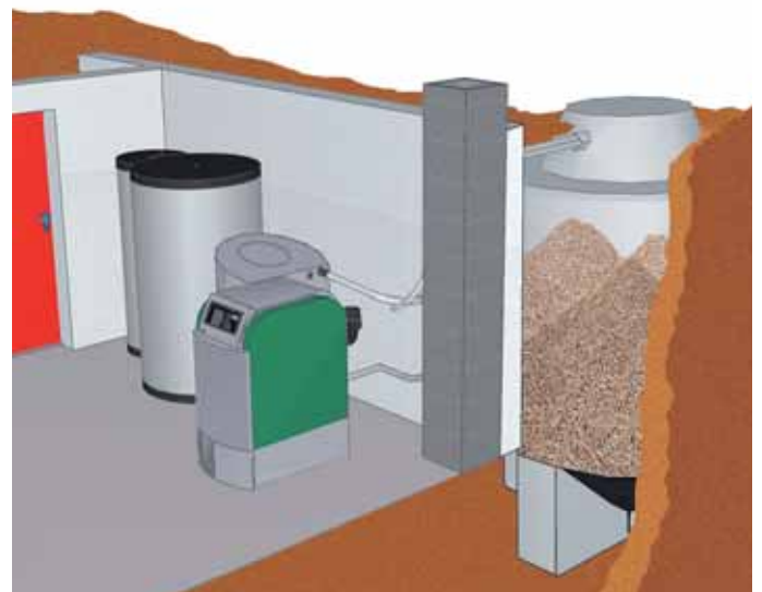
Raumaustragung mittels Saugaustragung aus einem Erdtank.
