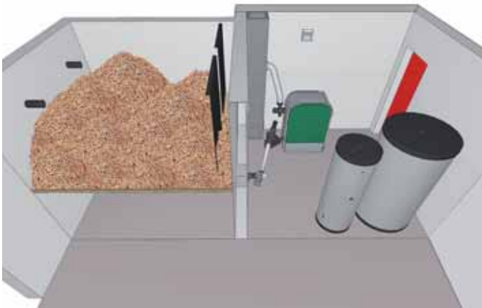
Raumaustragung mittels flexibler Austragungsschnecke mit Übergabesystem.
