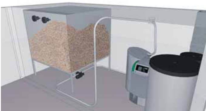
Raumaustragung mittels Saugaustragung aus einem Sacksilo.
