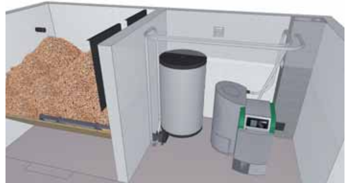
Raumaustragung mittels Austragungsschnecke in Kombination mit Absaugung.
