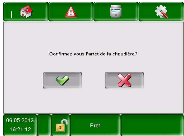
Image 2.1: Arrêt de la chaudière par saisie du code
