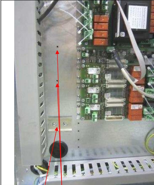
Fixez la barre de montage pour la protection moteur et deux trous pour le filtre d'alimentation
