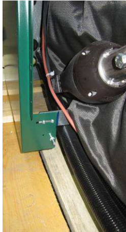
Dévissez les vis (haut et bas) de l'habillage latéral arrière gauche
