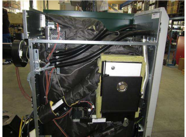
Ôtez le couvercle et l'habillage latéral arrière gauche
