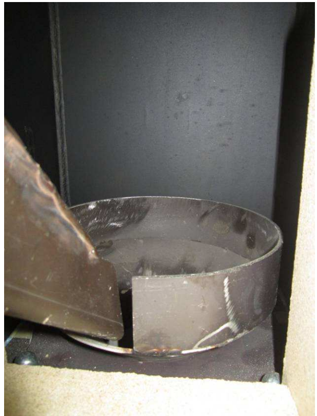
Nettoyez la chambre de combustion
