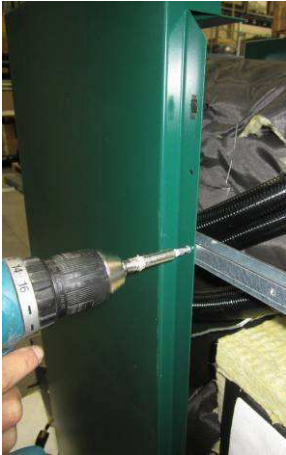
Dévissez les vis (haut et bas) de l'habillage latéral arrière gauche
