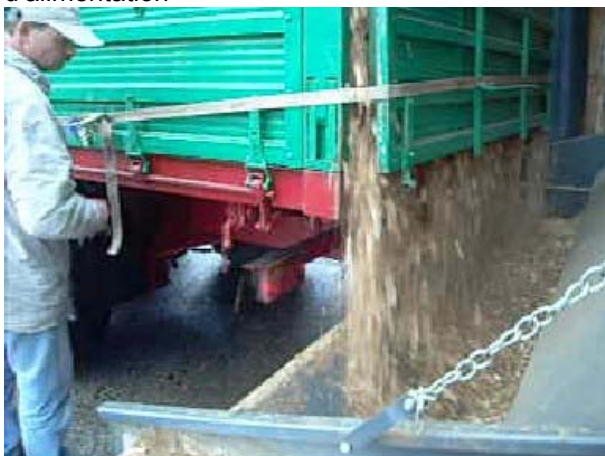
Illustration 2.1: Exemple d'un débit de remplissage « limité »
