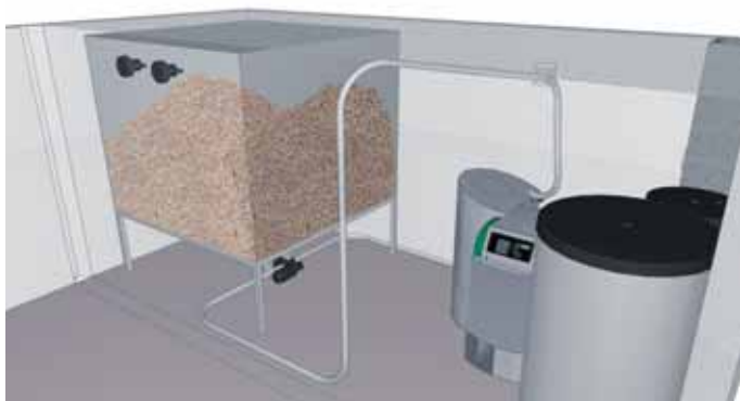
Extraction de silo tissu par système d'aspiration
