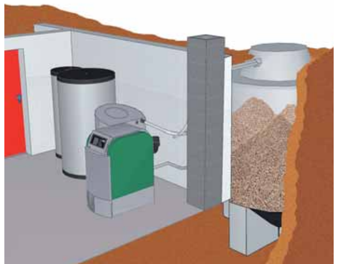
Extraction de silo enterré par système d'aspiration
