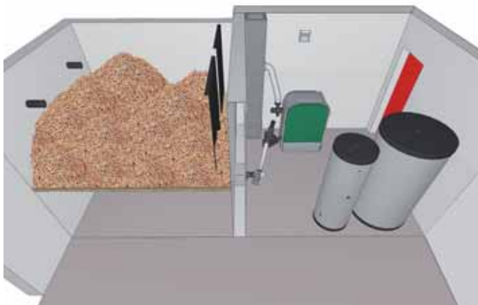
Extraction de silo par vis flexible avec système de reprise
