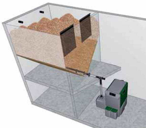
Extraction par vis flexible avec tube de chute
