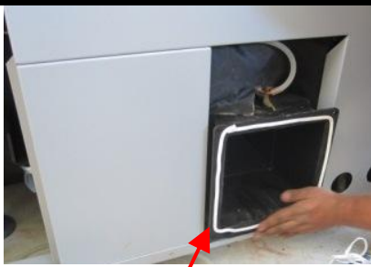
Montage du joint pour le moteur d'extraction des cendres.
