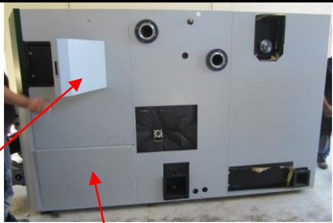
Montage de l'habillage n°6 de chaque côté du module foyer
