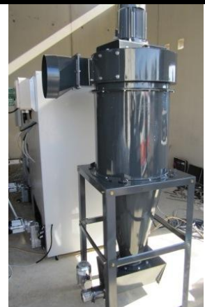
Poser le filtre cyclone selon le plan.
