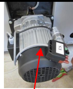
Montage du moteur de la vis de décendrage.
