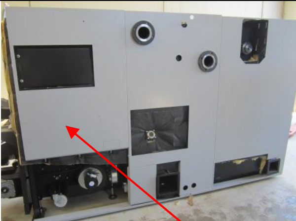
Montage de l'habillage latéral avant/supérieur gauche (droit) n°4
