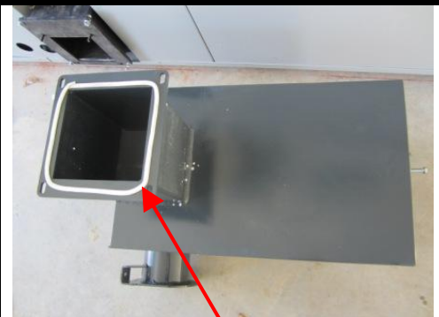
Montage des joints pour les cendriers (extraction des cendres).
