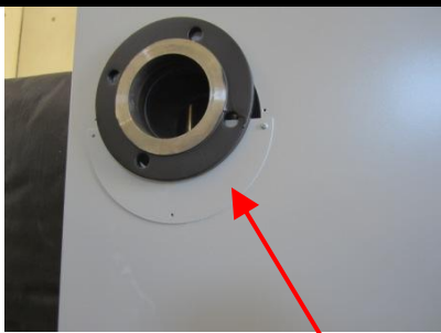
Montage du couvercle de protection départ 1
