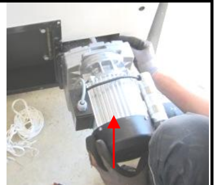
Montage du moteur d'extraction des cendres volatiles.
