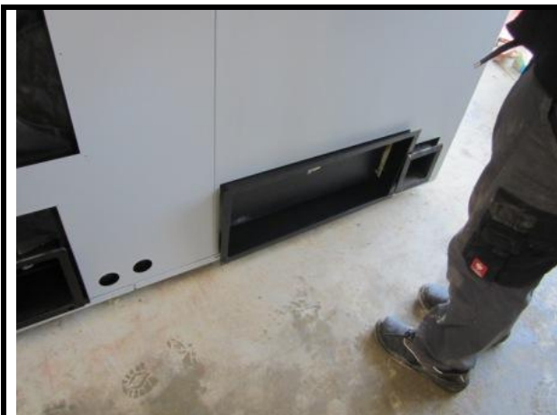
Montage du carter d'habillage pour le module de décendrage
