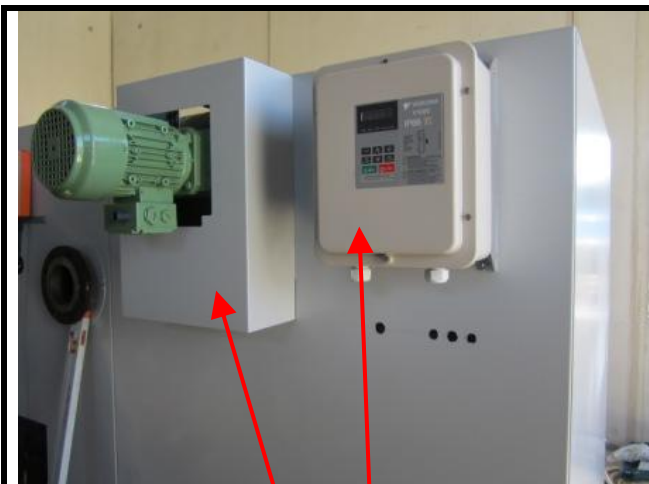
Montage de l'habillage pour le moteur des échangeurs et montage du boîtier de commande du ventilateur d'extraction
