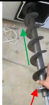
Positionner la vis d'extraction des cendres volatiles.
