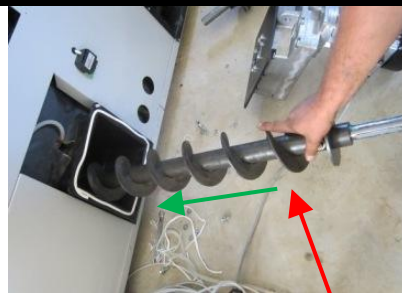
Positionner la vis de décendrage
