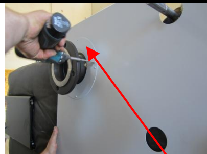
Montage du couvercle de protection départ 2
