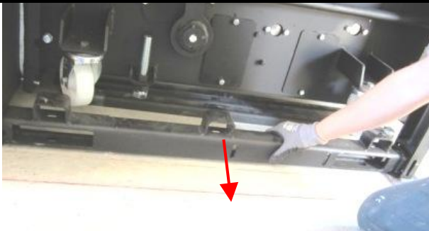
Entfernen des linken und rechten Seitenprofils und unter das Brennraummodul ablegen.
