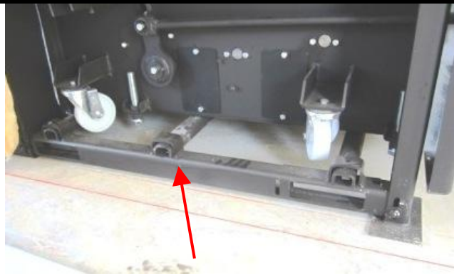
Entfernen der Transportprofile des Brennraummoduls links und rechts und unter das Brennraummodul ablegen.
