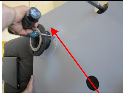
Montage der Abdeckung VL 2
