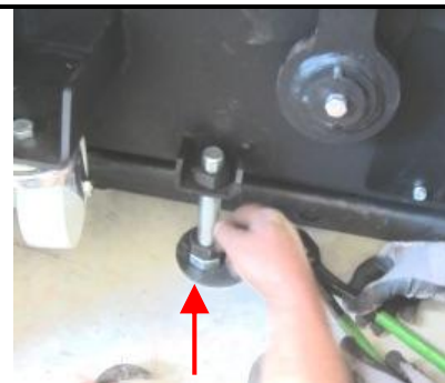
Unterlegscheibe platzieren und Schraube runterdrehen + kontern.
