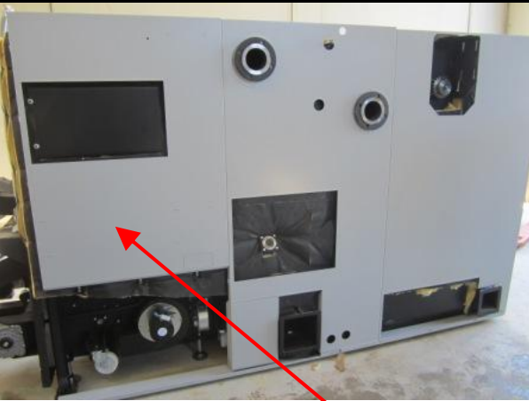
Montage Seitenverkleidung links vorne / oben (rechts) Nr.4
