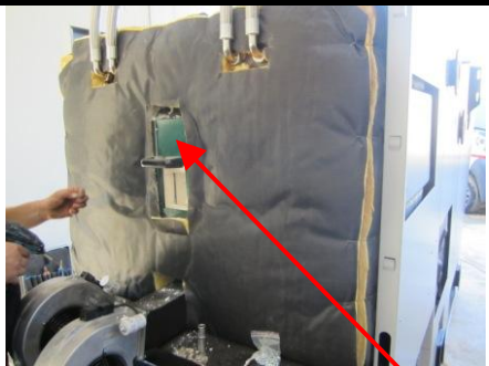
Montage der Abdeckung Stein-Schieber Schauloch
