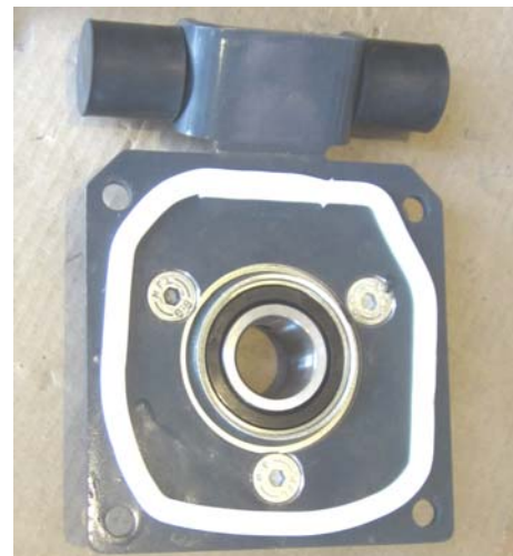
Faire ensuite l'étanchéité du support de bride avec le joint téflon autocollant fourni
