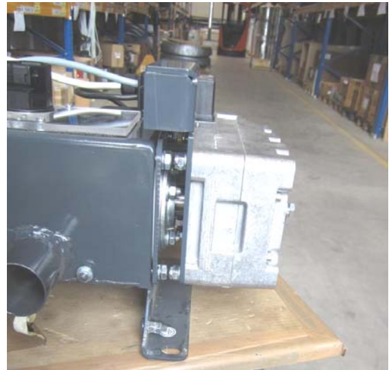
Support de réducteur de couple après montage
