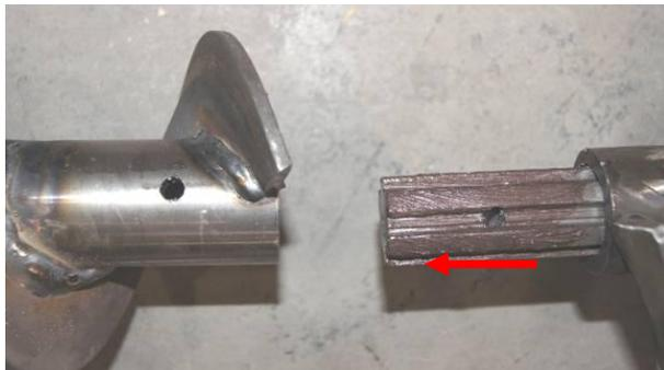
Assembler l'arbre cannelé dans la partie femelle.
