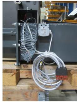
Monter la sonde de température silo sur le canal fermé et pousser le capillaire dans le conduit et l'habillage jusqu'à ce que le capteur apparaisse.
