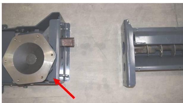
Les 4 écrous de sécurité M16 doivent être enlevés du réducteur de couple avant le montage.
