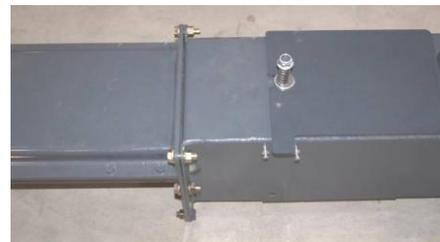
Positionner et monter la pièce de fin de la vis d'extraction. Il faut la visser avec les 7 vis M10x30 et écrous déjà prémontés.
