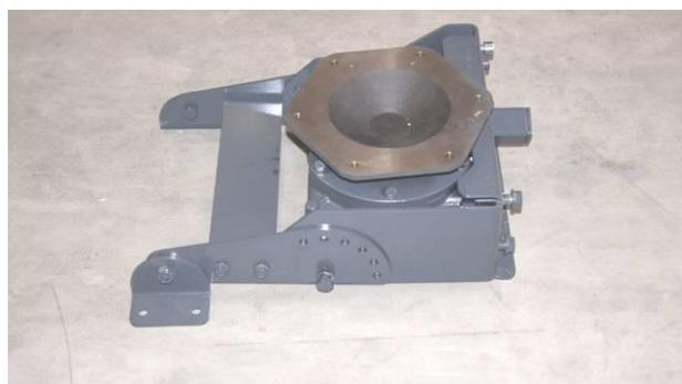
Le carré d'accouplement du réducteur doit être positionné dans l'alignement du perçage de silo.
