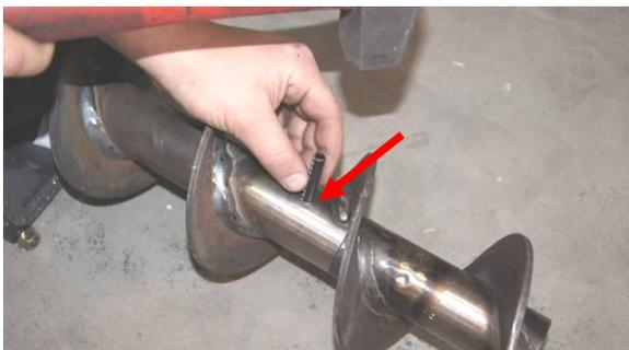
Positionner et monter la goupille. La goupille doit être à fleur après le montage !
