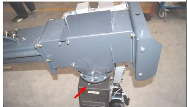
Positionnement et montage de l'assiette de décompression. Montage de la tête de transfert de l'extraction à la réserve intermédiaire de la chaudière.
