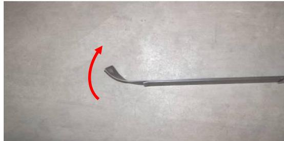
La spatule des pales du dessilleur doivent être orientées dans le sens de la rotation.
