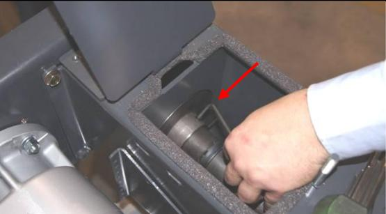
Aligner le disque de démarrage avec le perçage dans la tôle du tube de chute de la vis d'extraction et y fixer les deux vis pointeaux.
