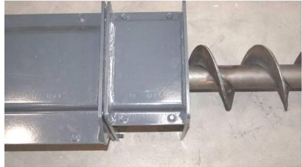
Positionner et monter a canal de vis fermé (longueur variable). Faire glisser le canal par-dessus la vis et le visser avec les vis M10x30 et les écrous M10.
