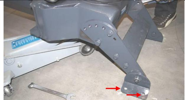
Fixation du réducteur de couple au sol. Sa position exacte dans le silo doit cependant être vérifiée une nouvelle fois.
