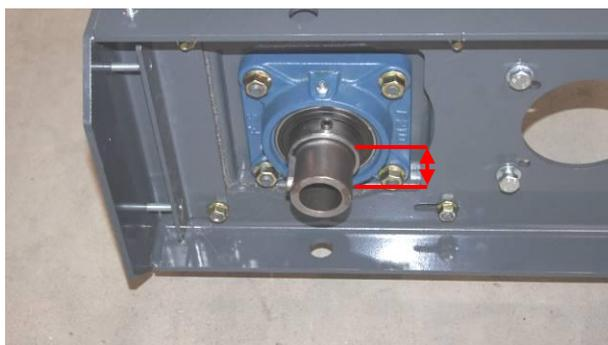
Contrôle de l'emboîtement de la vis sur la pièce de raccordement du réducteur de couple, la longueur de la vis en dehors du palier doit être de  $44\text{mm} \pm 2\text{mm}$ .
