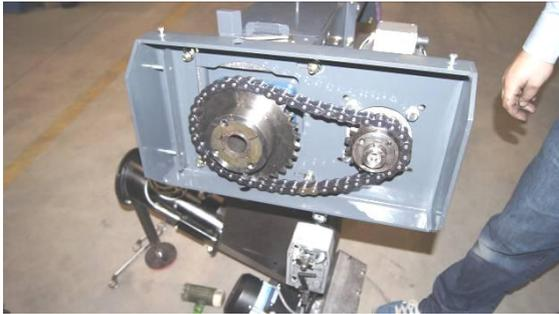
Montage et raccordement de la chaîne avec le ressort. Les maillons doivent être montés dans le sens anti-horaire.
