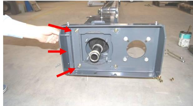
Positionnement et montage de la plaque moteur avec le tendeur de chaîne et les roulements. La plaque moteur doit être positionnée sur la pièce de fin de la vis d'extraction avec les vis M10x30 et des écrous, tout comme le tendeur de chaîne. Pour le montage des roulements, enlever la clavette et les assembler avec 4 écrous sur la pièce de fin de la vis (graissée). Contrôle d'écartement entre la garniture et la vis.
