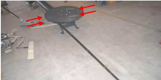
Fixer les 2 pales sur le plateau dessilleur avec 4 vis M12x40.
