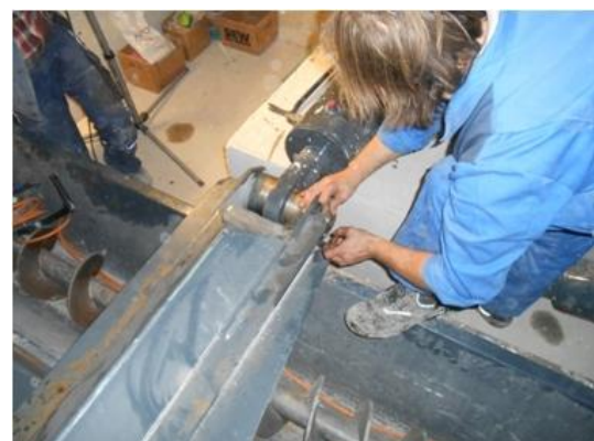
Image 3.33: Fixez les chevilles avec les vis et les écrous de sécurité
