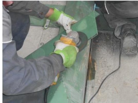
Image 3.35: Abrasez les sabots pour le soudage
