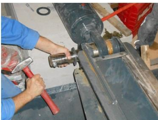
Image 3.32: Fixez les vérins sur l'échelle avec les chevilles
