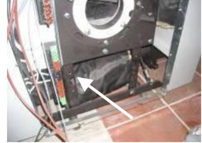
Vor Befestigung, Schraube am großen Zahnrad lösen, danach die gesamte Einheit an den vorgesehenen Bohrungen befestigen.
