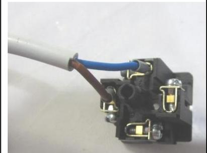
Blaues Kabel bei Nr. 3 braunes Kabel bei Nr. 2 anschließen (Beschriftung siehe Steckerrückseite)
