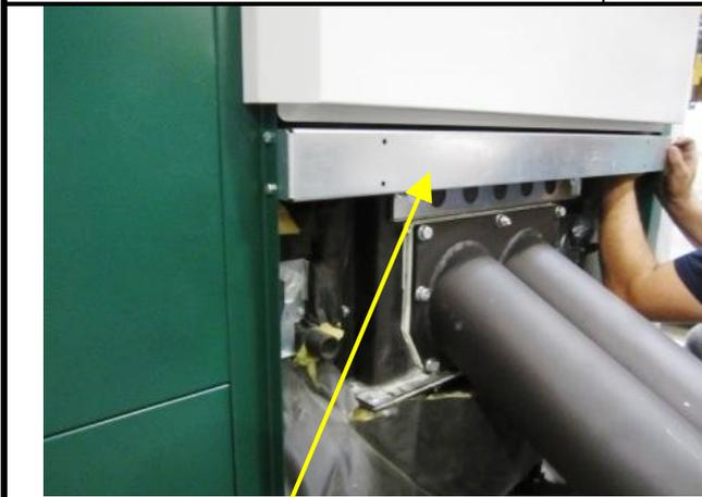
Montage des Bügels für die Verkleidungen des Einschubs mit je zwei 6-kant-Schrauben M6x20 links und rechts.
