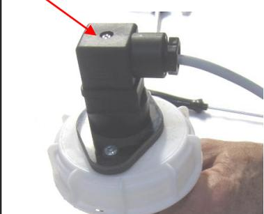
Steckerbuchse auf Stecker aufsetzen und Deckel mit Schraube fixieren
