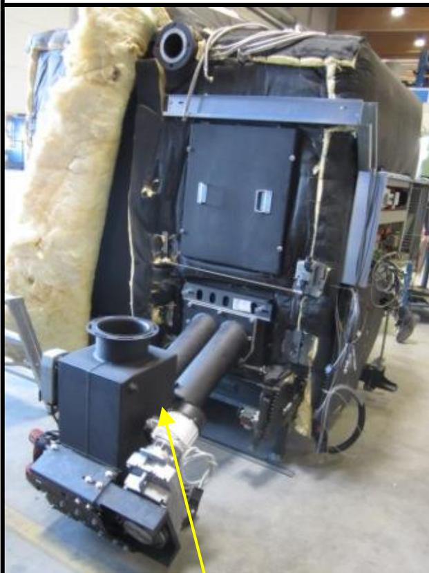
Positionieren und montieren sie den Einschub.
