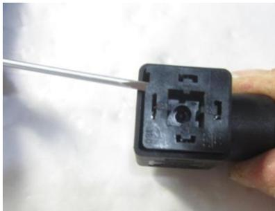
Deckel des Steckers demontieren
