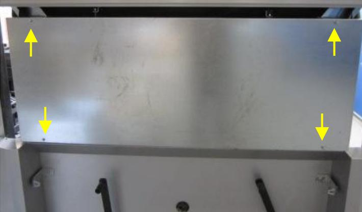
Montage der Schaltschrankabdeckung mit 4 Schrauben.
