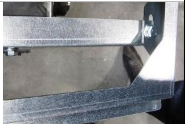
Montage des Verkleidungshalters für die Abdeckung des Einschubs mit vier 6-Kant-Schrauben M6x20.
