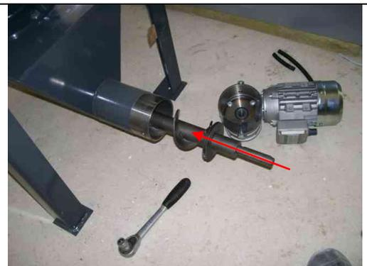
Insérer la vis dans le tube d'évacuation des cendres du cyclone.
