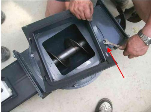
Dévissez la vis sur l'extrémité de la goulotte de transfert du canal en C pour orienter le support pour assembler la vis de reprise
