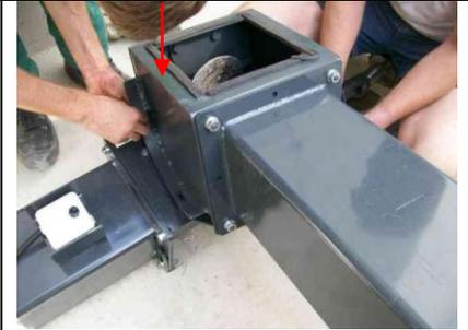
Inserer la vis de reprise sur le support et la commande sur la tourelle
