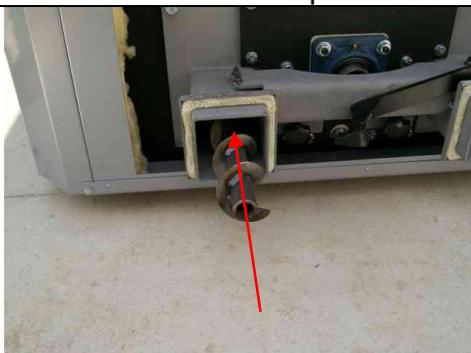
Insérez les vis de décrochage dans leur conduit et fixez les aux moteurs en graissant
