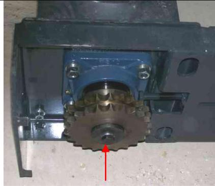
Placez la roue dentée sur l'axe de la vis d'extraction et serrez l'écrou central fermement
