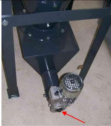
Serrer la vis sur le moteur. Positionner le moteur sur le tube et serrer les deux vis de maintien
