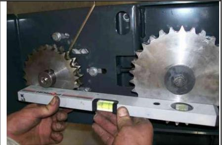
Placez le moteur sur sa plaque support et vissez le. Mettre l'engrenage sur l'axe du moteur. Aligner bien les deux roues dentées et serrer la vis pointeau
