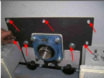
Dévissez les écrous de la plaque et enlevez la par le dessous ! Faites attention au joint d'étanchéité ! Remplacez le si nécessaire
