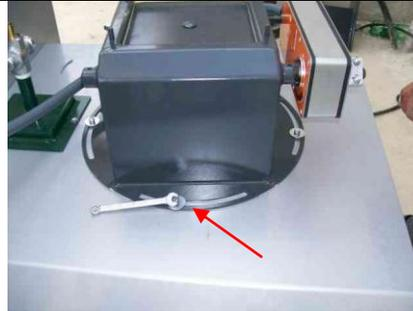
Devissser la vis sur la tourelle pour régler l'orientation de la vis sans fin!
