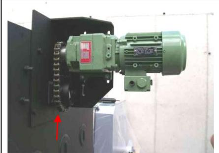
Montez le moteur du système de nettoyage à l'aide des échnageurs
