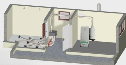
Figure : Réservoir d'aspiration DIRECT combiné à une extraction par aspiration 8 points
