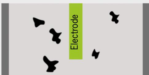
**01** Les fines particules de poussière traversent l'échangeur de chaleur avec les gaz de combustion, puis transitent dans les tubes de filtration électrostatiques intégrés
