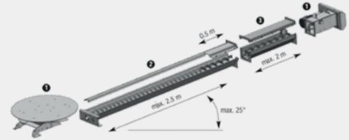
(1) Kit plateau dessileur pour système modulaire d'extraction 230V avec réducteur et berceau de fixation au sol.
