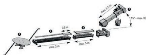
Kit basique pour système modulaire d'extraction 400V incluant kit de reprise 15 à 30° (Longueur max. 5 mètres)
