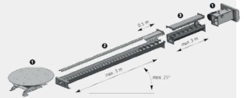
Kit plateau dessileur pour système modulaire d'extraction 400V avec réducteur et berceau de fixation au sol. 1 motoréducteur 400V avec sécurité thermique intégrée et support moteur.
