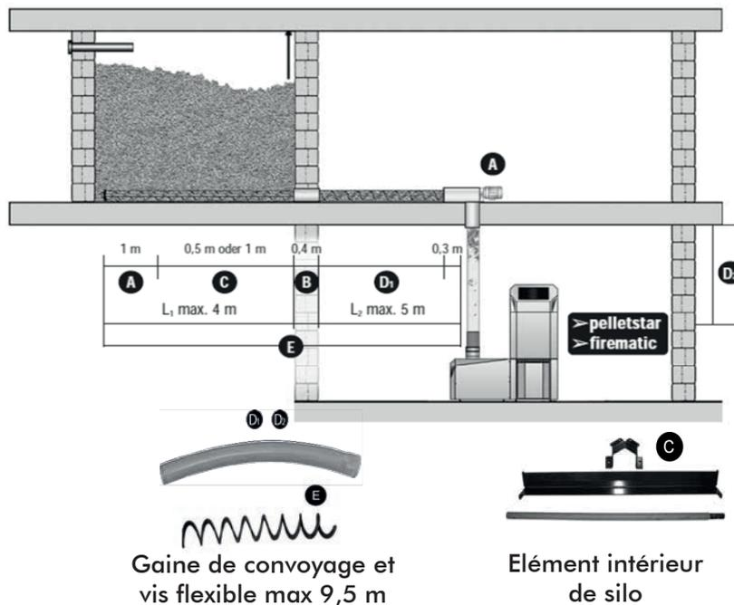
Gaine de convoyage et vis flexible max 9,5 m
