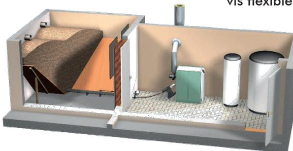
Rayon de courbure en extérieur du silo : minimum de 1,25 m
