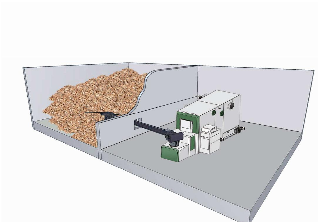
Capacité silo et autonomie : le silo de L 6m x l 6m x H 4m, permet d'obtenir un volume utile de 80 m<sup>3</sup>.
